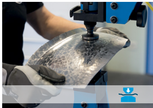
Glätten von vorgeformten Blechteilen
