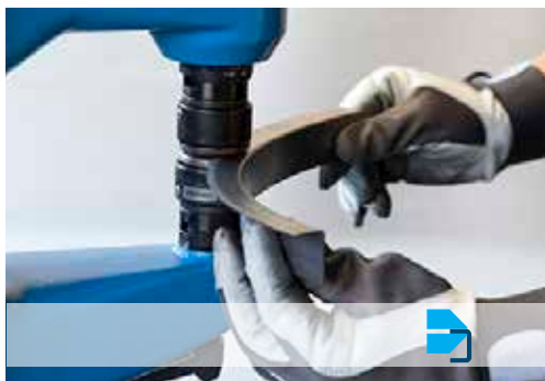
Stauen von U-Profilen mit geringer Steghöhe
