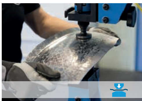
Glätten von vorgeformten Blechteilen
