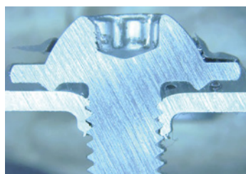
Schliffbild einer Direktverschraubung 直接螺钉连接的显微照片
