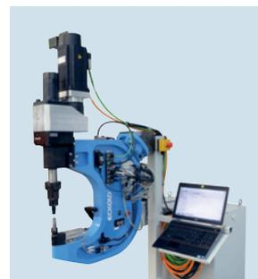
Schneidclinch-Bügel / Estribo de clinchado de corte por cizalla
