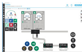
Angeschlossene Nietzuführstationen werden mit überwacht.
