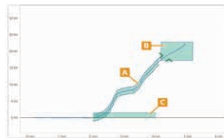
Procedimiento de monitoreo de proceso: técnica de curva envolvente (1), técnica de ventanas (2), monitoreo de tendencias (3)
