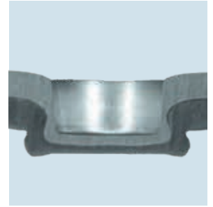
Sección de un elemento de clinchado óptimo como micrografía
