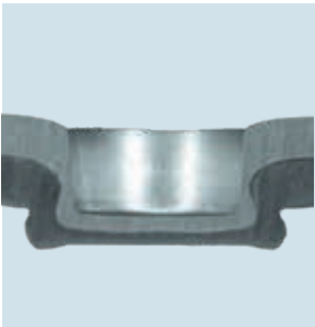
截面中的最佳咬合连接元件作为薄片显微图像
