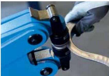
Stauen und Strecken an U-Profilen / Shrinking and stretching on U-profiles
